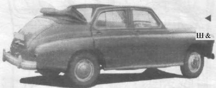
Комфортабельный джип ИЛЧ-72 на базе агрегатов «Победы» и армейской) внедорожника ГЛЗ-69
